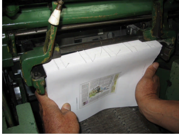
Resim 4 .2: Dikişi yapılmış bir kitabın makineden alınması
